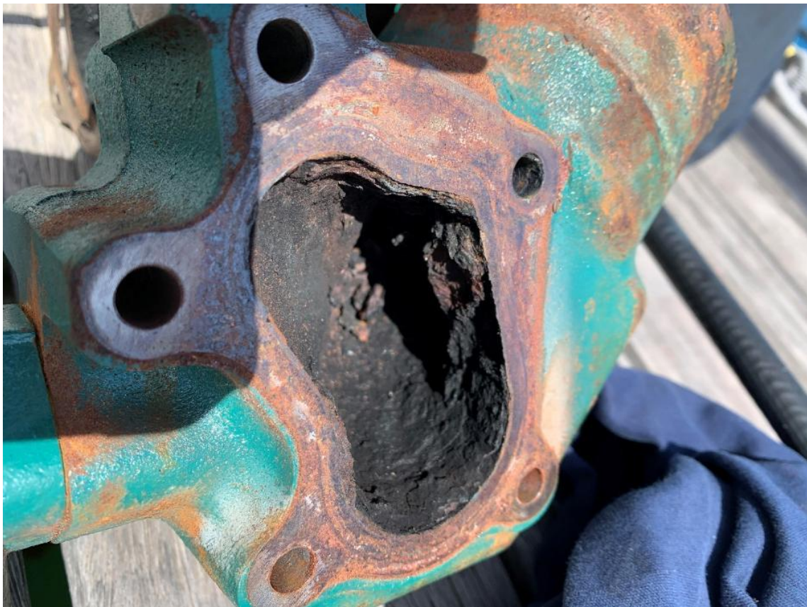
Chambre de sortie du turbo, partie coude d'échappement, aussi extrêmement corrodée.
