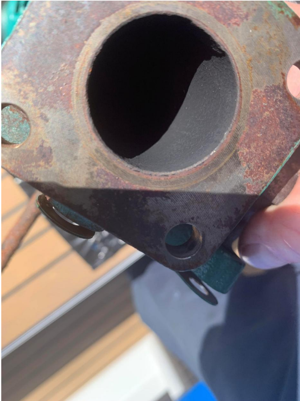
Turbo coté échappement, avant la turbine. À noter que cet échappement n'a que très peu de dépôts de suie.
