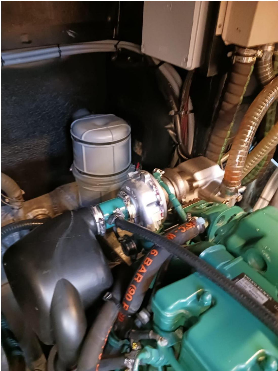
Un turbo tout beau et tout neuf. À noter le coude en inox aussi.
