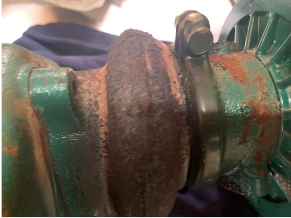
Corps extérieur de notre turbo, partie échappement, tout rouillé.
