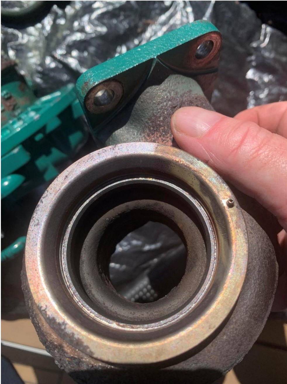
Intérieur du canal de la turbine coté échappement, chambre intérieure. Aucune accumulation de suie, mais on notera de la corrosion en sortie du canal dans la chambre d'échappement extérieure du turbo. À noter aussi la goupille fendue d'alignement sur la photo.
