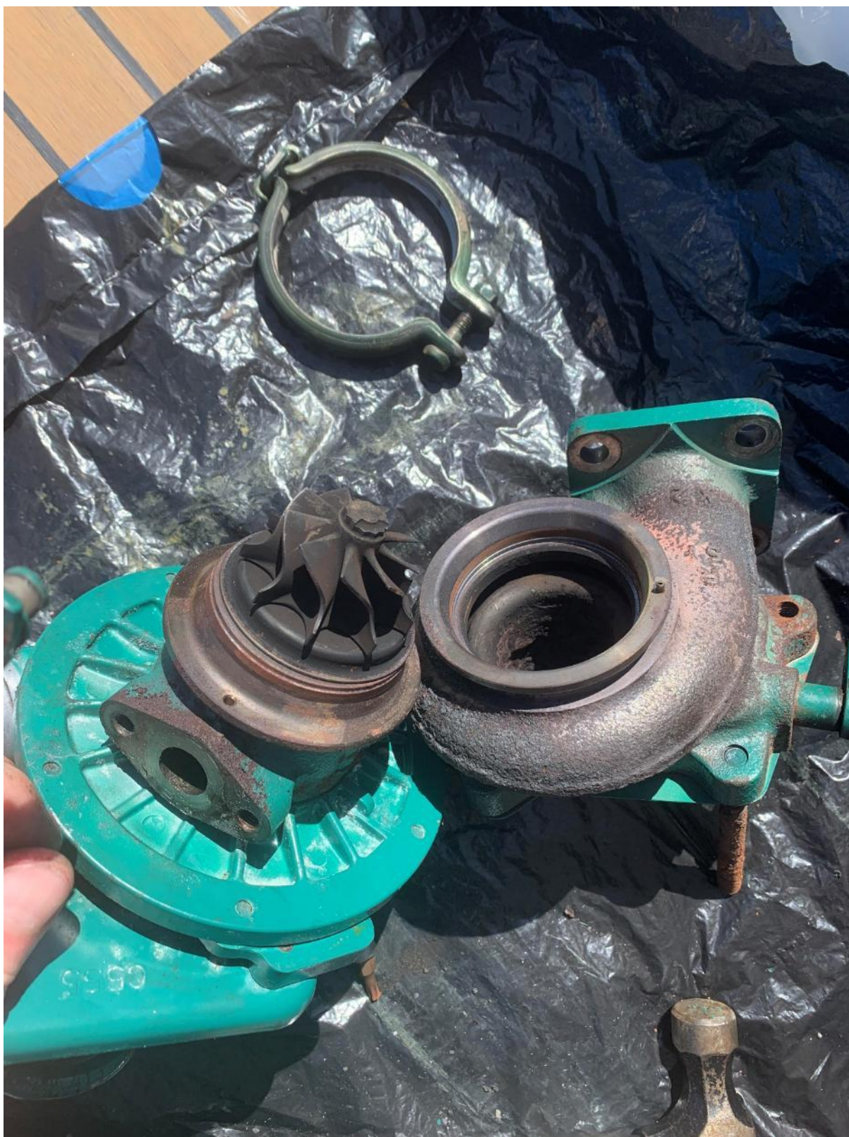
Chambre intérieure d'échappement du turbo ouverte. À noter la goupille fendue et le trou d'alignement pour remonter le turbo précisément après un nettoyage.
