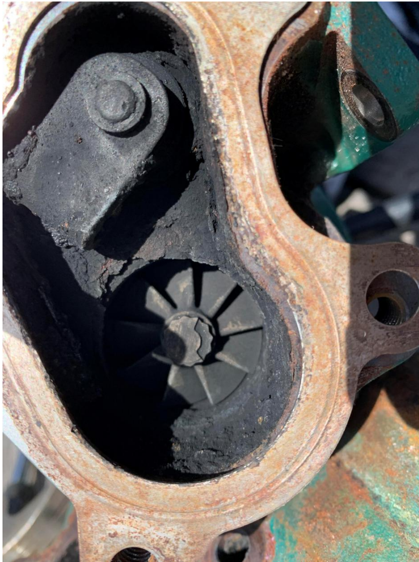
Chambre de sortie, partie turbo après la turbine d'échappement, avec une vue de la turbine. À noter la corrosion de la soupape de surpression, et vers le cylindre de la turbine.
